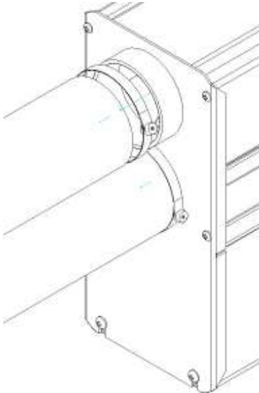
Abb. 7: Die Schläuche zum Gebläsekanalsystem werden mittels Schlauchschellen fixiert
