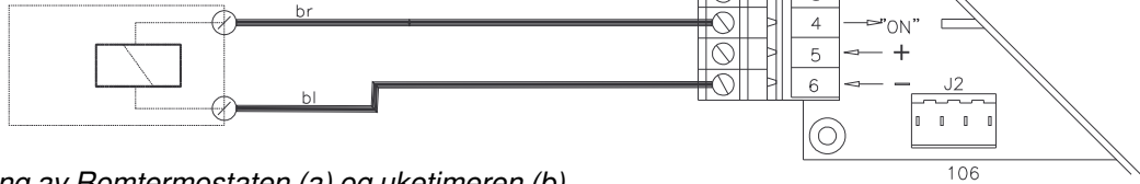
Bilde 20. Tilkobling av Romtermostaten (a) og uketimeren (b).
