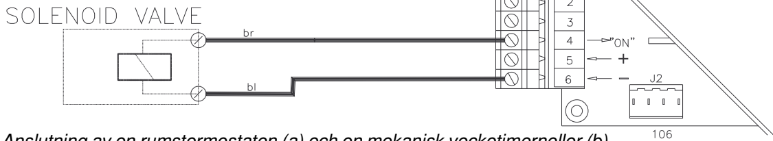
Figur 20. Anslutning av en rumstermostaten (a) och en mekanisk veckotimerneller (b).
