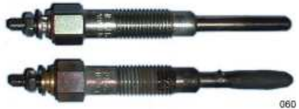
Kuva 9: Ylempänä ehjä hehkutulppa ja alempana rikkoinen oikosulussa oleva hehkutulppa.
