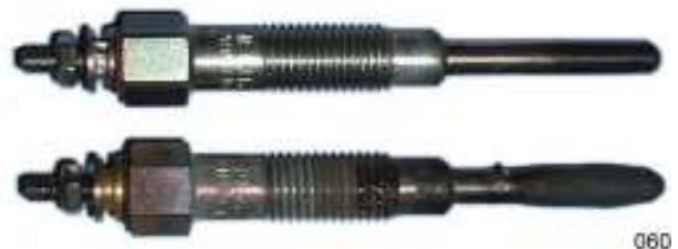
Figur 9: Den övre bilden visar ett helt glödstift och den nedre bilden ett trasigt glödstift i kortslutning.
