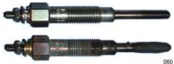
Bilde 9: Det øvre bildet viser en hel glødestift, og det nedre bildet en kortsluttet glødestift som er i stykker.
