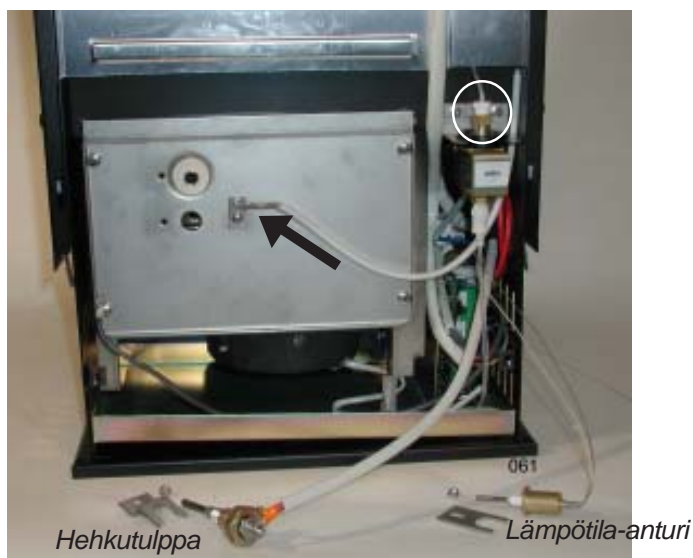
Kuva 9: Ylempänä ehjä hehkutulppa ja alempana rikkoinen oikosulussa oleva hehkutulppa.
