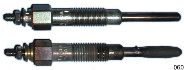
Figur 9: Den övre bilden visar ett helt glödstift och den nedre bilden ett trasigt glödstift i kortslutning.
