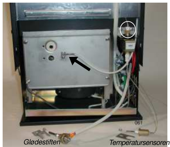
Figur 9: Det øvre bildet viser en hel glødestift, og det nedre bildet en korts-luttet glødestift som er i stykker.
