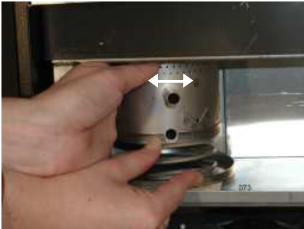
Bilde 15: Montering av brenneren.
