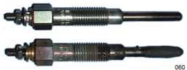
Figur 9: Det øvre bildet viser en hel glødestift, og det nedre bildet en korts-luttet glødestift som er i stykker.
