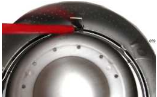
Bilde 13: Demontering av varmestråleren.
