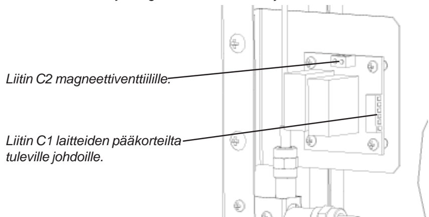
Kuva 4: Relekortin ja magneettiventtiilin kiinnitys liesiuuniin.
